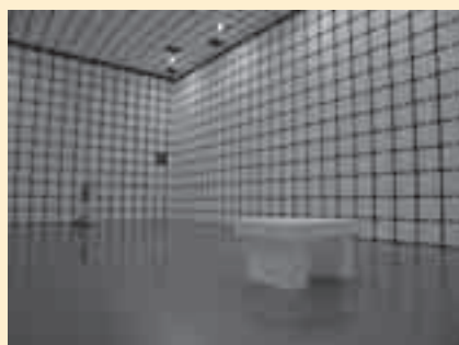
10m 法電波半無響室
