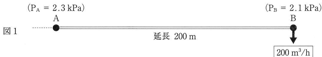
今、図2のようにAB間の中間点(A点から100 m)のC点にもガスを  $200 \text{ m}^3/\text{h}$  供給することになった。A点の圧力  $P_A$  が 2.3 kPa のとき、B点の圧力  $P_B$  (kPa)として最も近い値はどれか。ただし、高低差は考慮しないものとする。
