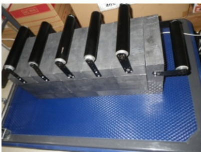
鉛遮蔽設備外観
