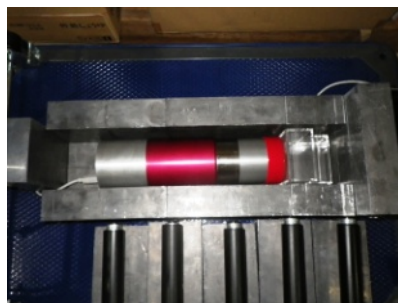
鉛遮蔽設備内の EMF211 装置
